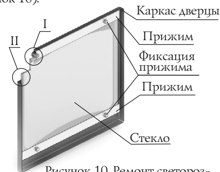
Рисунок 10. Ремонт светопрозрачного экрана дверцы.
