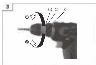
Проверьте правильность установки переключателя крутящего момента шпинделя. При работе с разными материалами совместите одну из цифр «1, 2, 3 ... 18» или значок  $\wedge$  на переключателе и треугольный значок на внешнем корпусе
