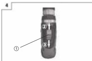
Скорость вращения может быть изменена с помощью переключателя(1). Двигайте переключатель(1) в направлении стрелок(2 и 3). Если переключатель установлен на «I», сверло вращается медленно. Если переключатель установлен на «II», сверло вращается быстро.
