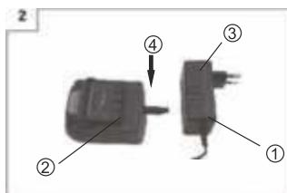
Подключите зарядное устройство(1) в розетку, светодиод начинает светиться зеленым цветом, штекер(2) установите в гнездо зарядки батареи(3), предварительно сняв батарею.
