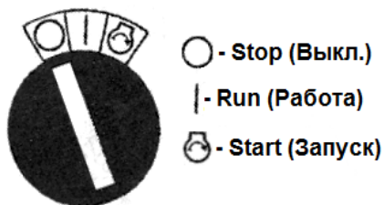
Рис.13. Замок зажигания (электростартер). Ключ в положении "O" (Выкл.).
